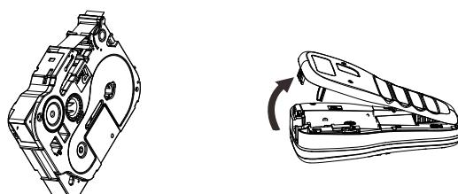
1. 检查色带前端不能存在卷曲，需正确通过色带导向部分；
